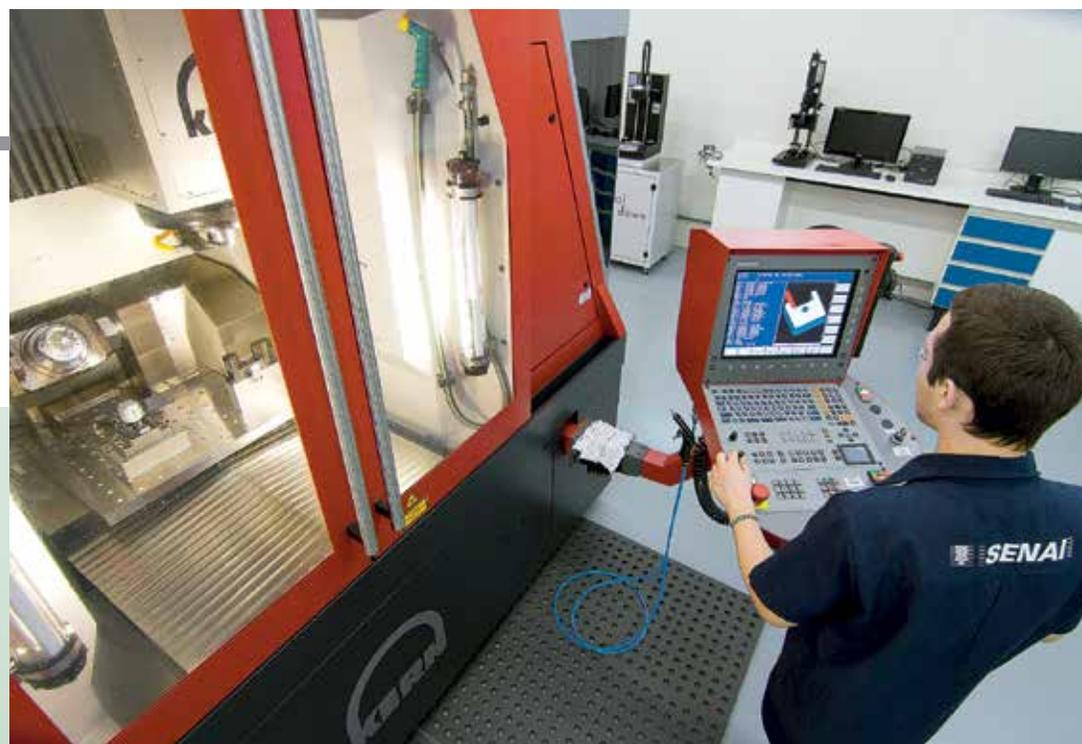
*Sistema de microusinagem, do Instituto de Joinville: fabricação de peças milimétricas com alta precisão*
